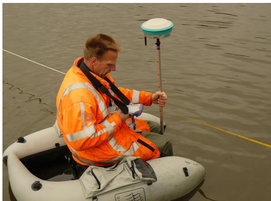
Links: Waterschap Hollandse Delta; peilstok met GPS. Rechts: Certicon; peilstok met regelbare tegendrukmeter
