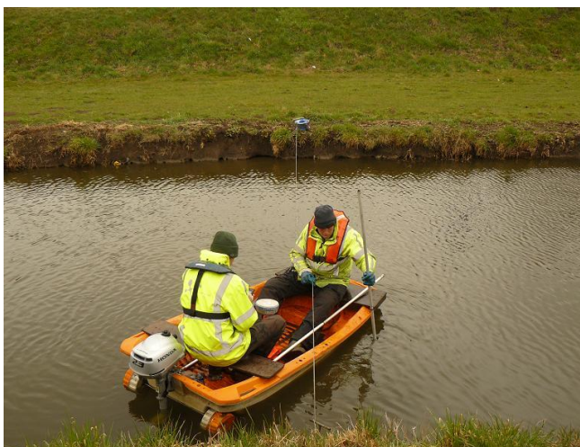
Tijhuis Ingenieurs; demo van de conventionele methode: de peilstok.
