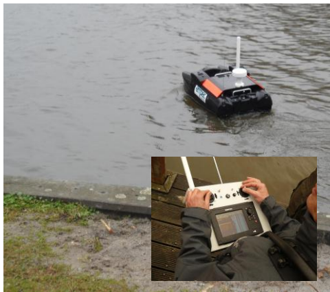
Links: Intech/Empec, radiografisch bootje met grondradar en sonar. Rechts: Intech; digitale peilstok InDepth.
