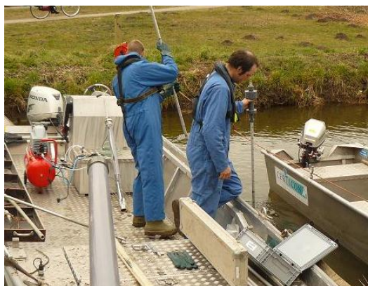
Links: Waterschap Hollandse Delta; peilstok met GPS. Rechts: Certicon; peilstok met regelbare tegendrukmeter
