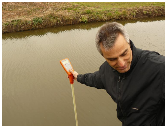
Links: Intech/Empec, radiografisch bootje met grondradar en sonar. Rechts: Intech; digitale peilstok InDepth.
